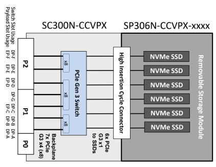
StorePak (SP306N-CCVPX) + Carrier (SC300N-CCVPX) Block Diagram
